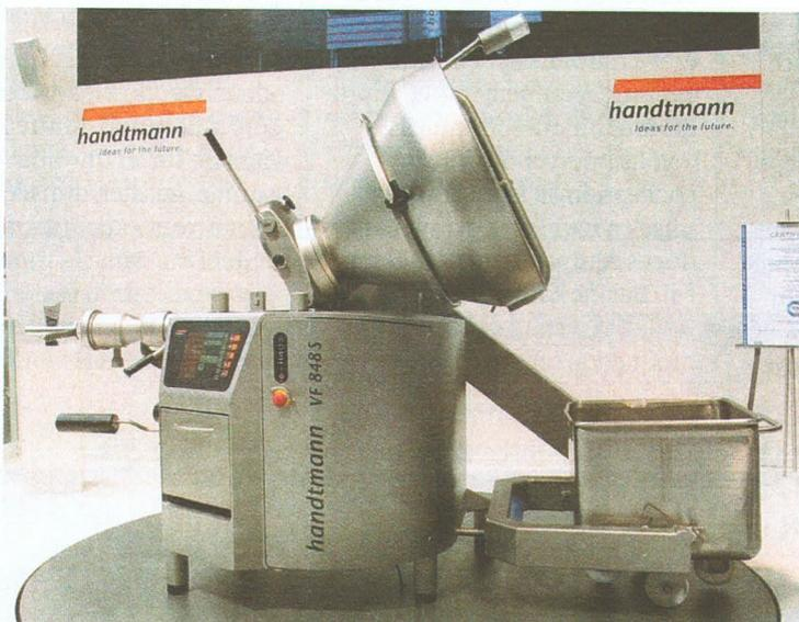
● **Hygiène** : le VF 800 est doté d'un programme de nettoyage intermédiaire à l'eau chaude (90 °C), et des lampes UV équipent l'évacuation d'air.
